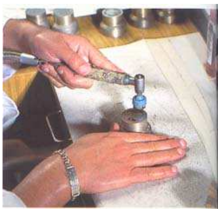
Ilustración 54 – Pulido de Troqueles con pasta de diamante
