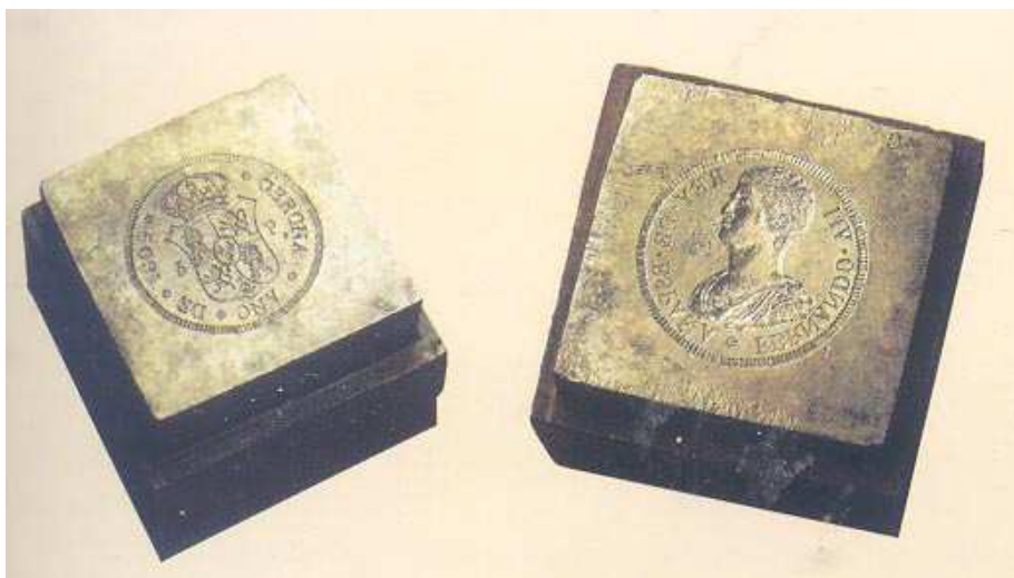
Ilustración 18 - Troqueles de una moneda de Fernando VII de forma rectangular pertenecientes a una prensa volante
