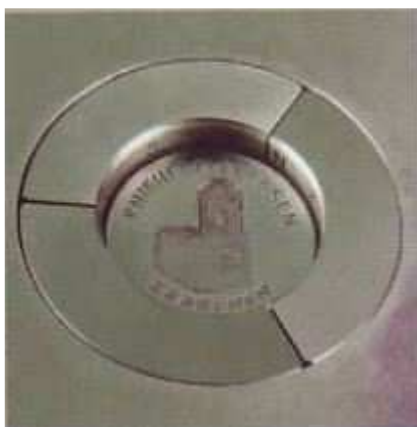
Ilustración 76: Virola segmentada de 3 piezas con leyendas incusas
