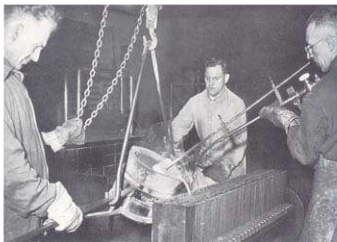
Ilustración 40 – El metal fundido se vertía en la rielera, con moldes en forma de lingotes
