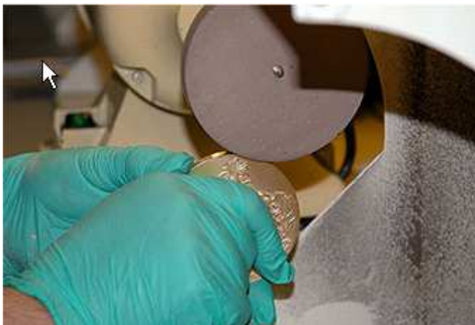
Ilustración 70 - Por efecto de la acuñación sin virola la medalla se expande y se lima su canto en un torno.
