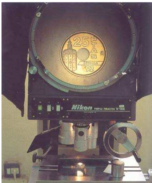
Ilustración 62 – Control de Calidad. Proyector de Perfiles que sirve para revisar el estado y desgaste del troquel a partir de una moneda recién acuñada tomada como muestra
