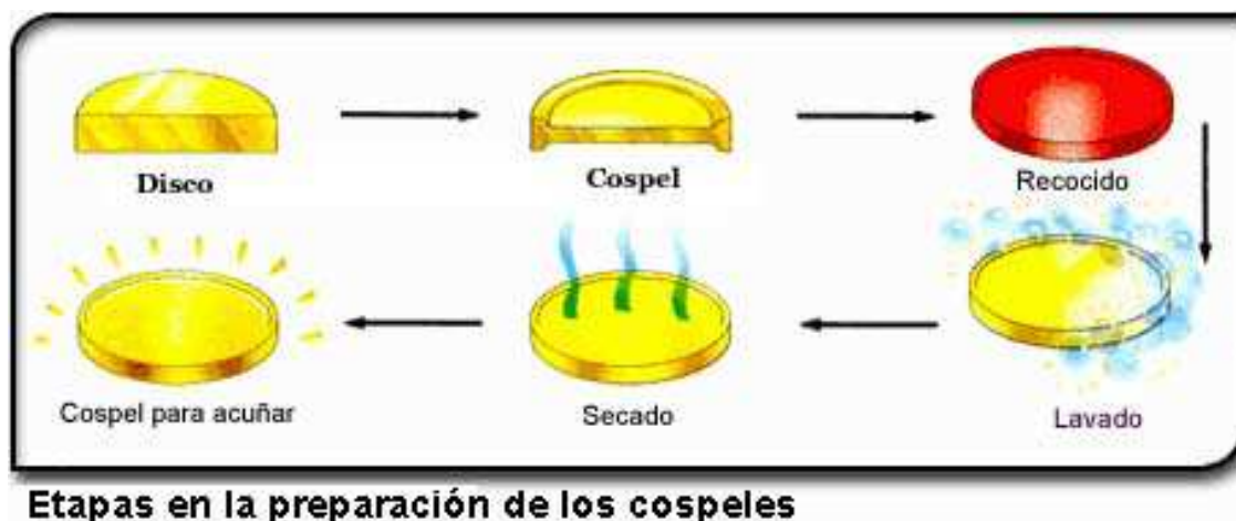
Ilustración 59 – Etapas en la fabricación de los cospeles
