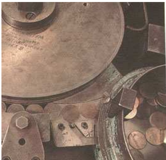
Ilustración 57 – Tórculo que convierte los discos en copeles.
