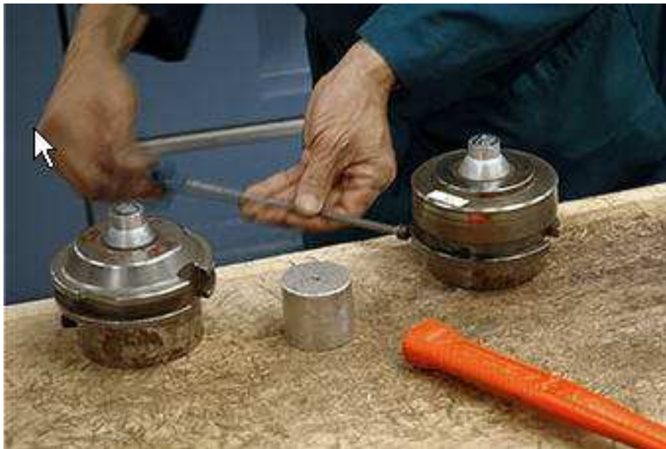
Ilustración 65- Instalación de los troqueles en el útil que se monta en el prensa. Instalación en el portatroqueles y a la prensa.
