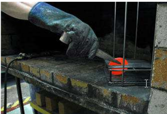
Ilustración 71 - La medalla es recocida para facilitar una nueva acuñación
