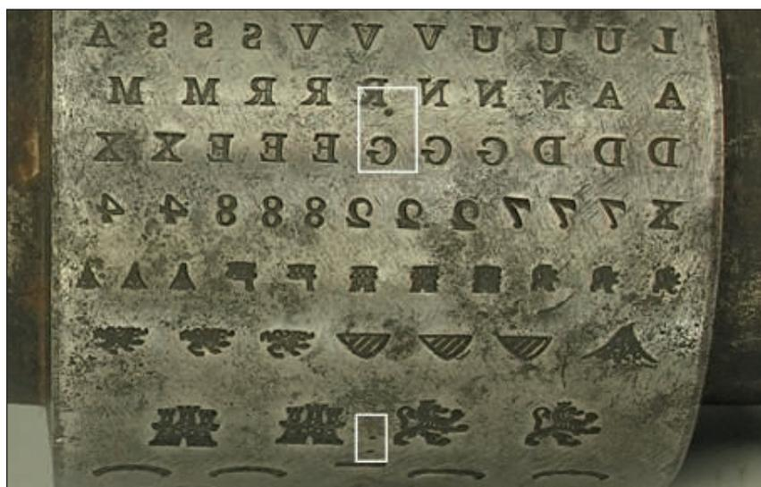
*Fig. 7. Detalle de pruebas de hincado de punzones en un rodillo. Fotografía Glenn Murray*
